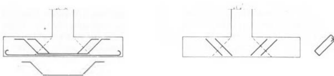
Figura 6.10 - Armadura transversal de punção em sapatas.
